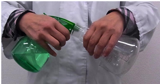
写真.1 空のフラスコ内面に水を噴霧
